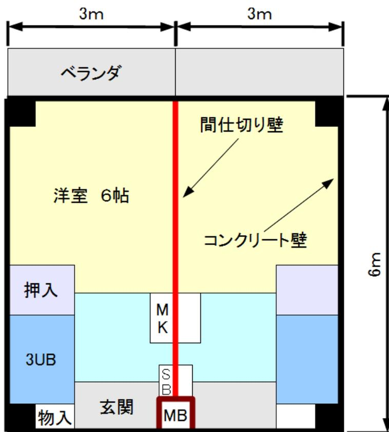
6m四方に柱を配置し、夫々の柱間に梁を渡し、鉄筋コンクリート壁で区画します。ワンルームマンションの場合、この1区画を半分にし、間仕切り壁(軽量鉄骨で壁の骨組みをつくり、両側に石膏ボードを貼り付けた壁)を設けて、2住戸をつくります。コンクリート壁側は遮音性が高いのですが、間仕切り壁側は低くなります。鉄骨造やプレハブ造においては、端部屋でない限り両側の壁が間仕切り壁となります。
